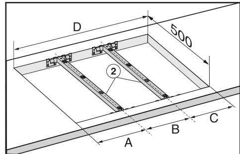
При встраивании **трех** приборов ширина выреза в столешнице D получается из размеров А и В и С.
