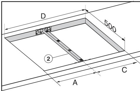
При встраивании **двух** приборов ширина выреза в столешнице D получается из размеров А и С.
