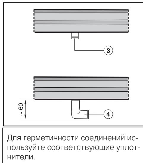
Для герметичности соединений используйте соответствующие уплотнители.
