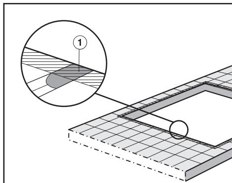
Стыки ① и заштрихованная область под поверхностью прибора должны быть гладкими и ровными, чтобы рамка лежала ровно и уплотнение под кромкой верхней части прибора обеспечивало достаточную герметизацию столешницы.
